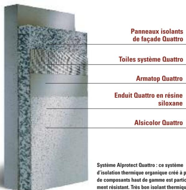
Système Alprotect Quattro : ce système d'isolation thermique organique créé à partir de composants haut de gamme est particulièrement résistant. Très bon isolant thermique, il est également très résistant aux souillures.
